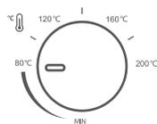
**Termostato:** Nível de aquecimento mínimo do aparelho de **80°C a 200°C.**
